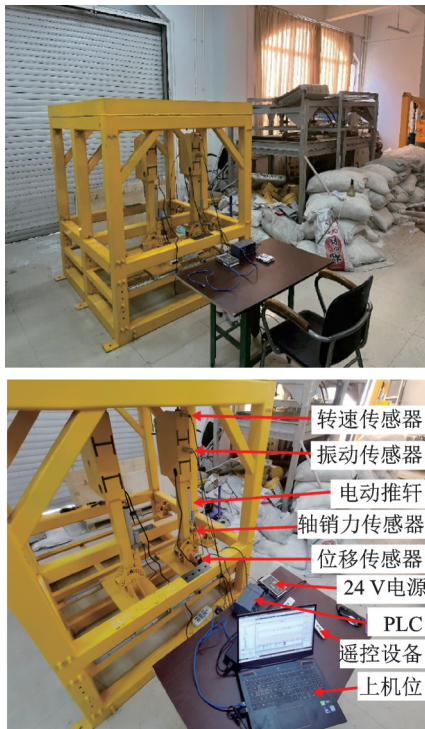
图6 锚固钻进模拟试验台
