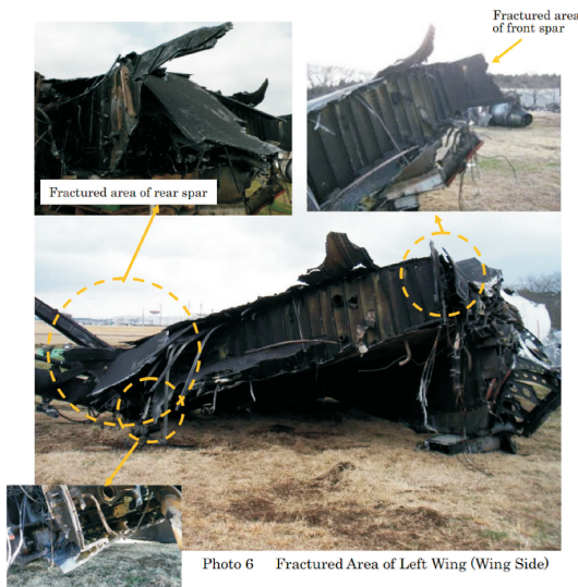
图12 严重重着陆引起机翼断裂细节图 [40]
