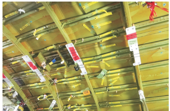
图11 重着陆引起前机身上部蒙皮长桁以及隔框结构损伤细节图 [61]
