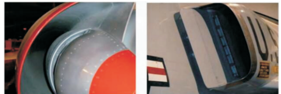
图6 战机进气道中的边界层抽吸控制
