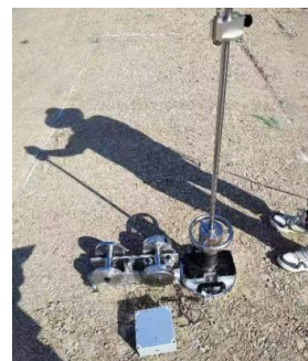
图 4 现场冲击荷载法测试照片 Fig.4 Photograph of field impact load testing method
