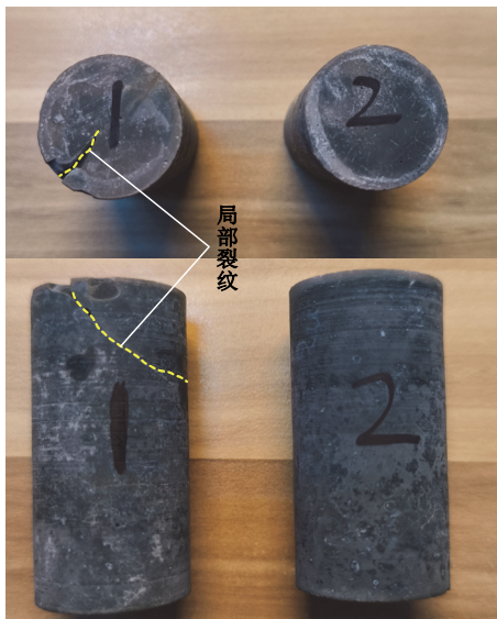
图 8 正面岩心试样 1, 2 的裂缝差异对比图
