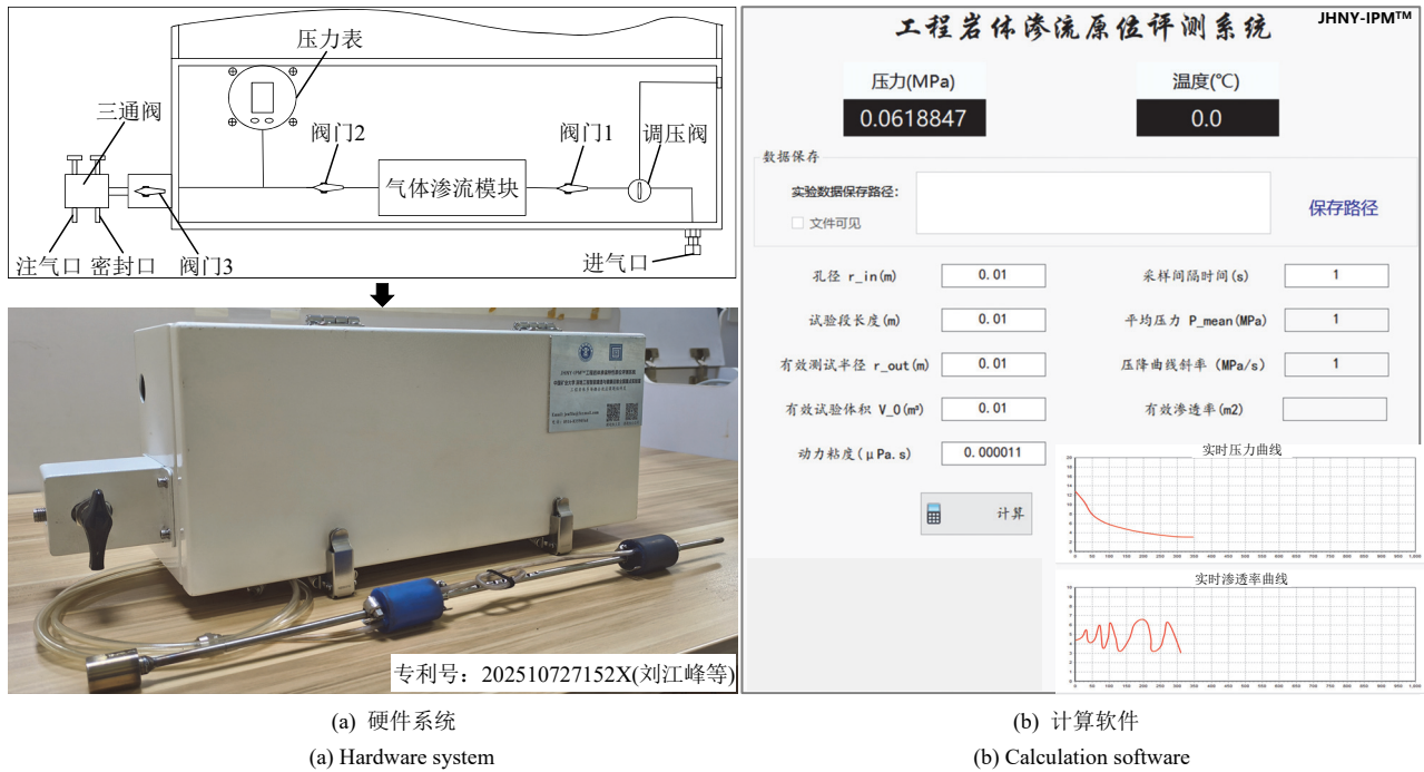
图 5 工程岩体渗流演化原位评测装置研制及配套测试软件示意图
