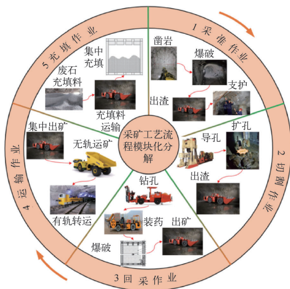
图3 新型采矿工艺全流程作业图
