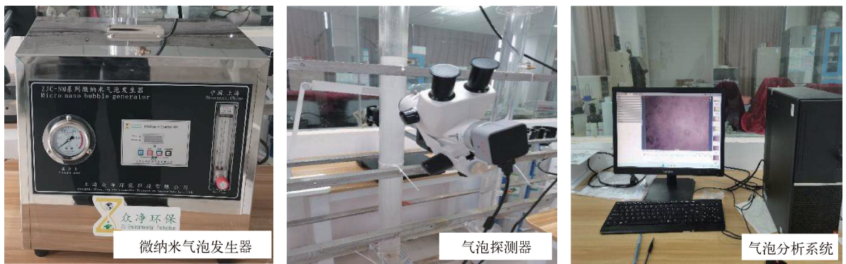
图 4 微纳米气泡混氧试验模型
