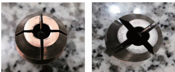
图4 夹头焊接前后附着金属飞溅物对比
