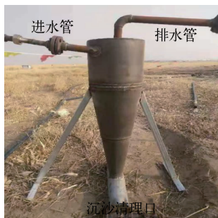
图3 洗井废水除砂装置实物
