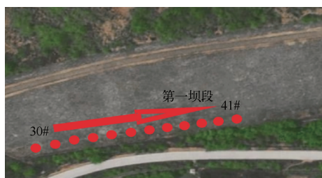
图 2 第一坝段排渗管埋设布点图
