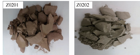
图 4 洗井水沉降物干渣照片
