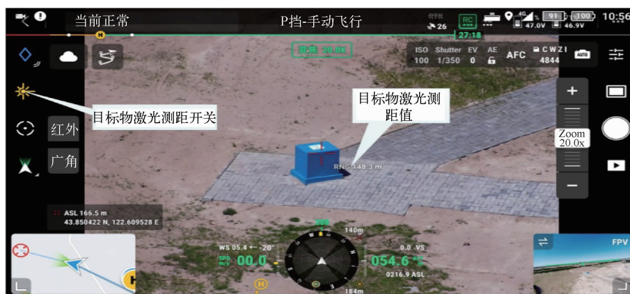
图 3 激光测距精准定位
