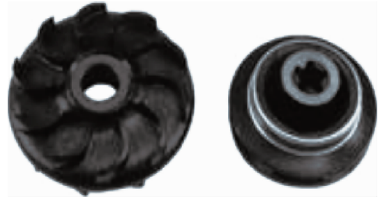
图 3 尼龙叶轮和碳化钨轴承形貌
