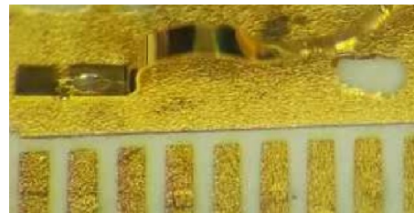
图12 基板表面的空洞 Fig 12 The void on substrate surface
