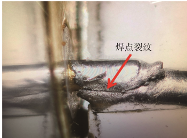
图 1 锡焊焊点裂纹 [4,5]
