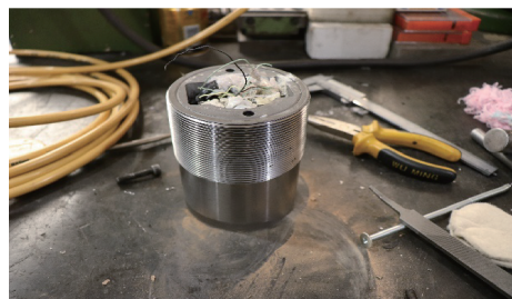
图 5 切削弹体取出的内部存储器
