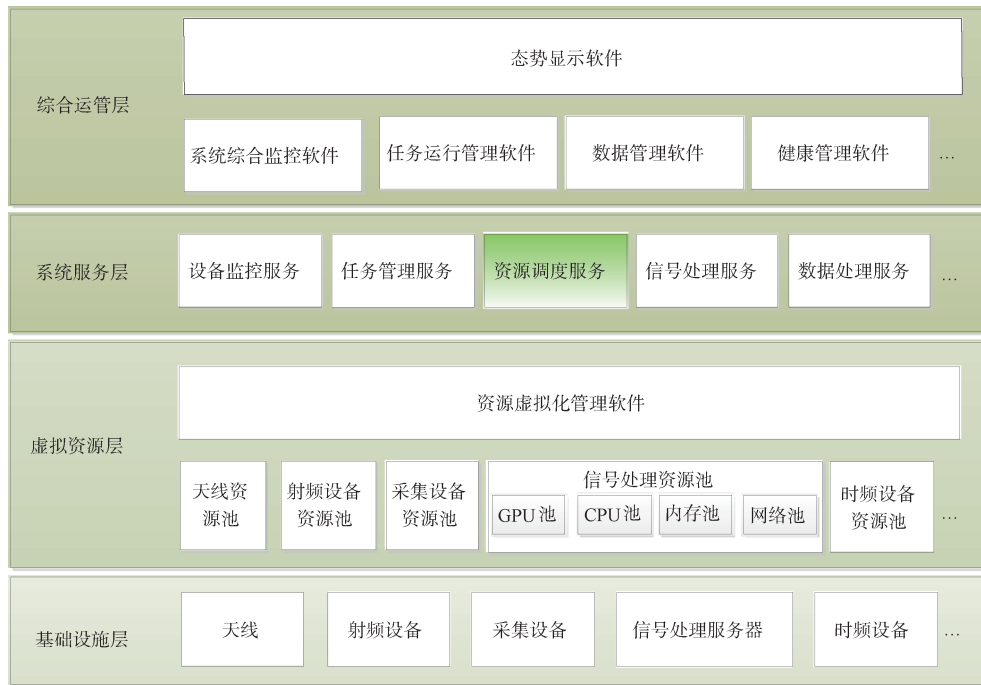
图1 资源池综合运管平台总体架构
