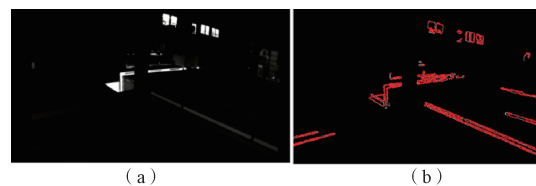
图 3 原图(a)和 Canny 边缘检测结果(b)
