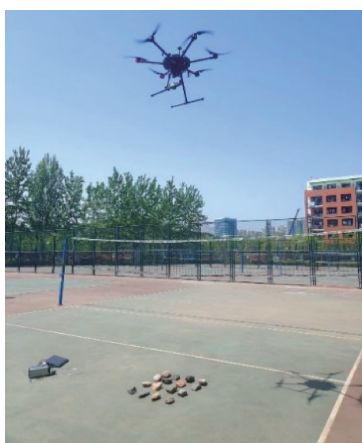
图8 无人机高光谱采集现场照片
