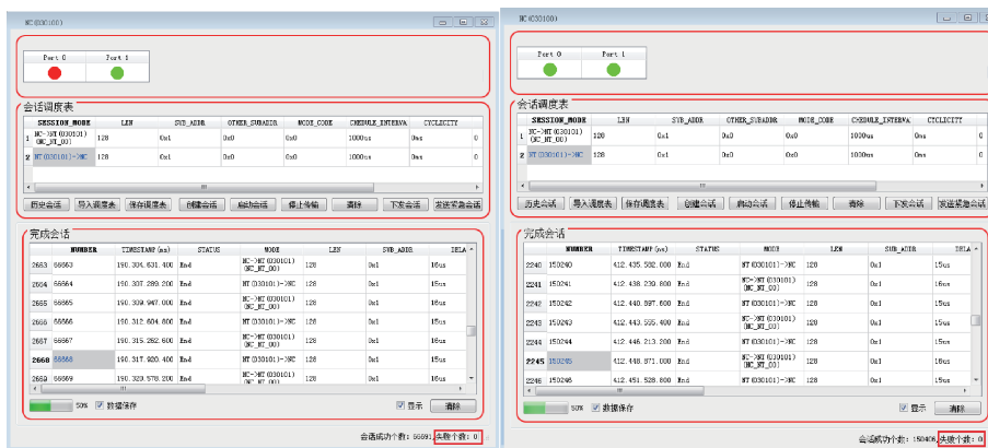
图 15 NC 断开 A 路总线后以及重新连接 A 路总线后通信图
