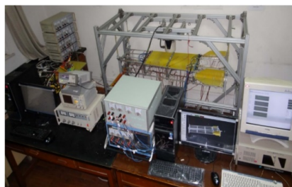
图 9 模拟飞行器结构形态重构与可视化实验平台 [22]
