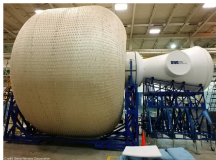
图 12 连续分布式光纤传感器直接编织于柔性结构约束层织带 [28]
