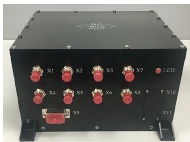
图18 北京卫星环境工程研究所碰撞泄漏检测系统主机
