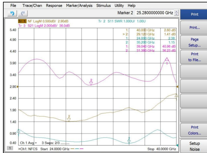
图 11 Ka 频段超宽带低噪温放大器实测数据
