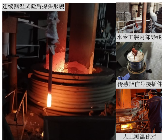
图 10 LF 炉钢水环境现场测试
