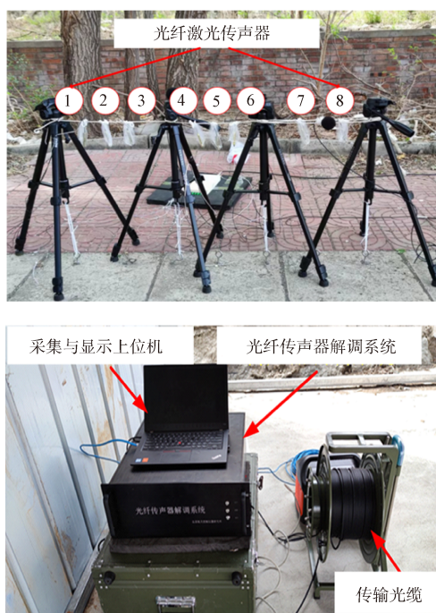
图5 外场实验环境中光纤激光传声器阵列及其解调系统噪声采集现场图
