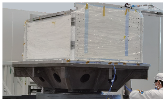
图10 Z轴振动试验现场
