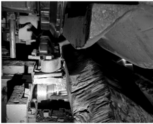
图 5 改进后的轧机 UR 导卫装置
