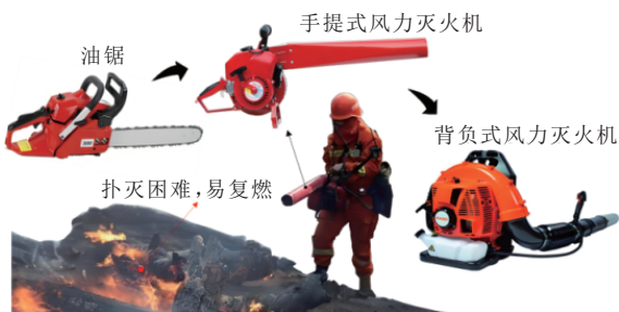
图2 风力灭火机演变及其缺点
