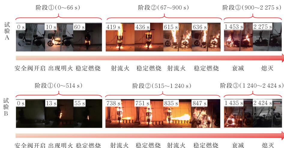
图6 电动自行车火灾燃烧演化图
