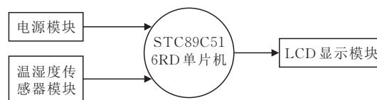
图5 温湿度检测模块系统框架图
