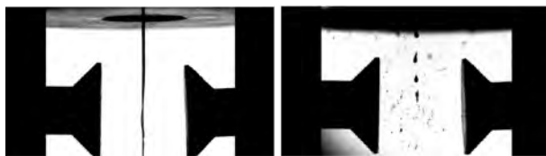
图 6 高速相机下非接触超声雾化制粉
