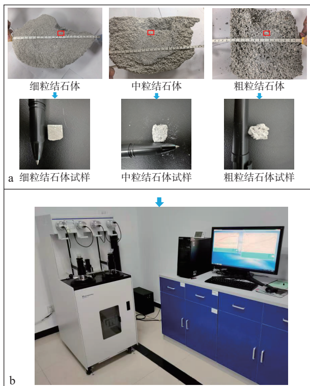
a. 结石体试样获取; b. 结石体试样的压汞实验
