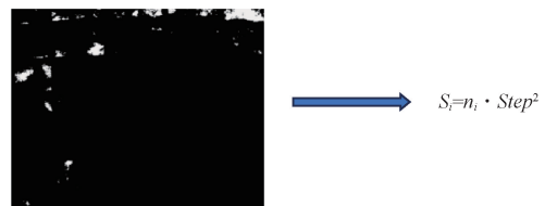
图 8 基于二值化图像的渗水面积快速统计
