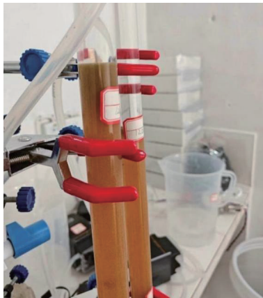
图8 运行20个批次后上层树脂状态 Fig. 8 Upper layer resin after 20 cycles
