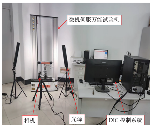
图1 微机伺服万能试验机及DIC测试系统
