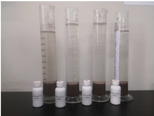
图4 絮凝剂选型试验结果图 Fig. 4 Results of flocculant selection test
