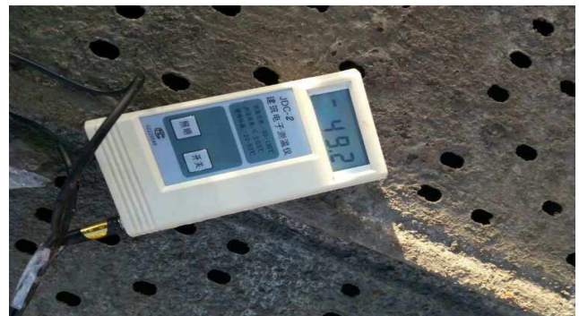
图2 混凝土传感器检测
