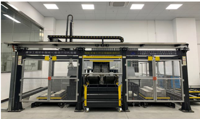
图1 建筑材料智能化检测设备
