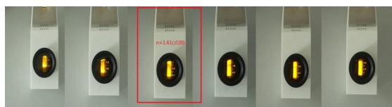
图13 磨砂刻面的无色托帕石(9#)的非标准态点测
