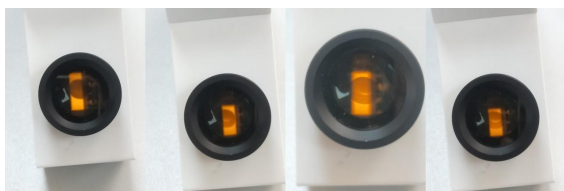
图5 只有一小块亮斑随着油滴影像的移动而移动
