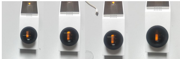
图6 锆石(3#)的点测仅有全亮和全暗两种状态
