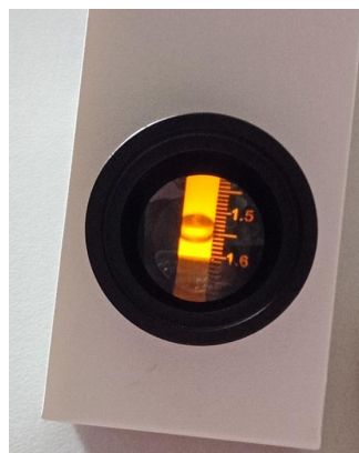
图3 无色合成水晶珠子(8#)的标准态点测
