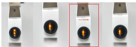
图10 弧面形蓝宝石(7#)的非标准态点测
