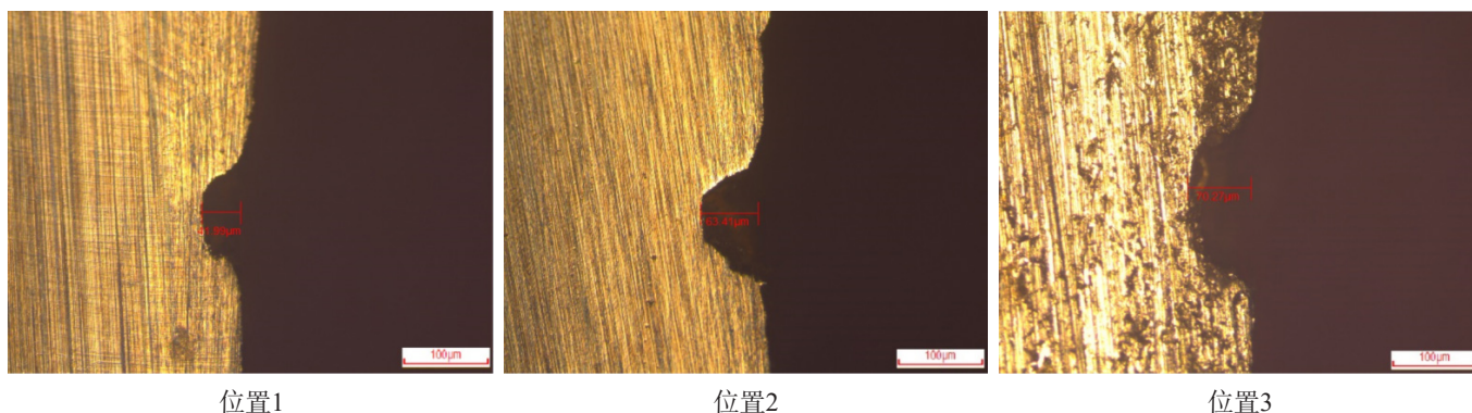
图 4 不锈钢板点蚀坑的金相测量
