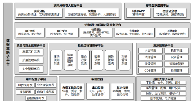
图 3 实验室信息化管理系统及对外服务系统架构图
