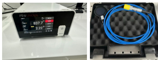
图 3 辐射测量系统
