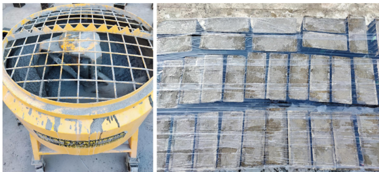
图 1 UHPC 试块浇筑现场
