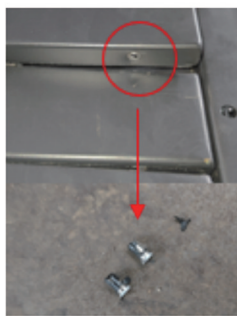
(i) 上部侧板卡扣断裂
