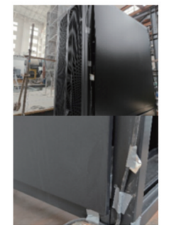
(h) 两侧侧板屈曲脱扣
