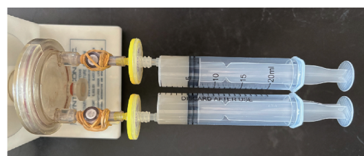
图 3 液体培养试验用的 RCCS-2D 和针筒照片
