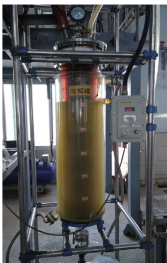
图 3 NAVOI MINING 公司 U 3 O 8 的硝酸连续溶解试验现象
