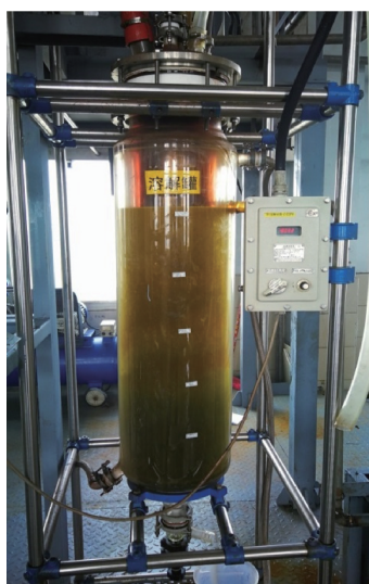
图 2 NAC KAZATOMPROM 公司的 U 3 O 8 硝酸连续溶解试验现象
