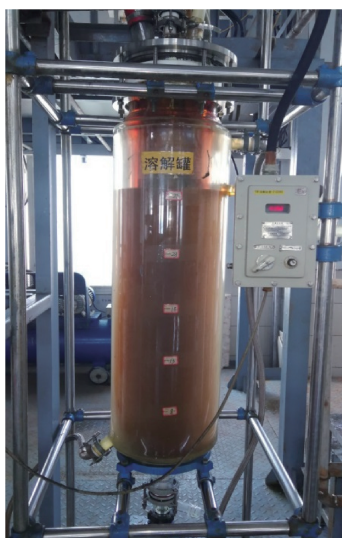
图 4 哈萨克斯坦 KATCO 公司 U_3O_8 的硝酸连续溶解试验现象
