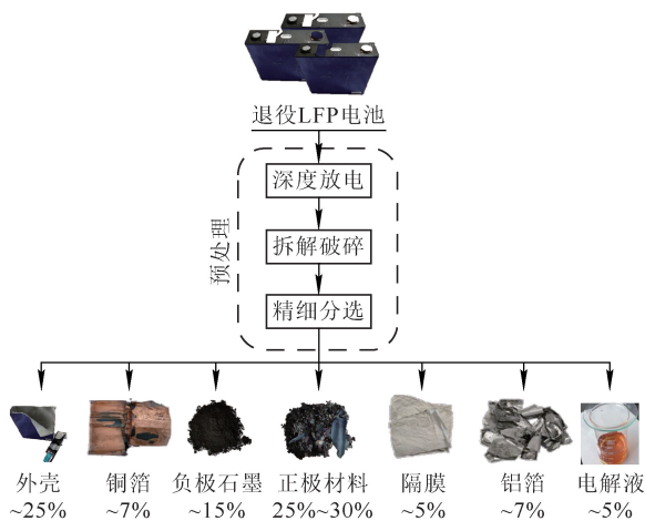
图 1 退役 LFP 电池的预处理流程
