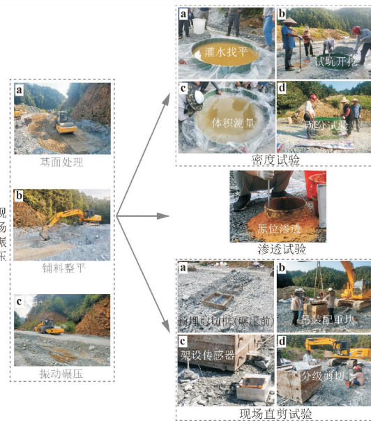
图 3 现场碾压试验流程
