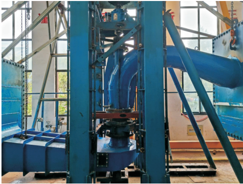
图 7 安装在试验台上的水泵装置模型
