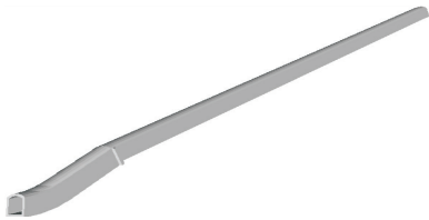
图 2 #1 泄洪洞数值计算模型
