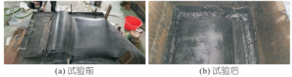
图 9 鼓包形态试验前后对比
