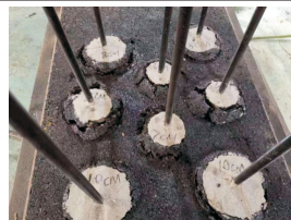
图 6 不同孔径拉拔试验破坏现象
