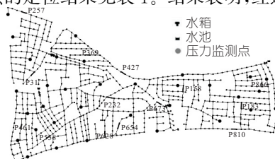
图 6 L 镇供水管网概况图
