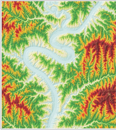
数字表面模型(DSM)是以规则网格表达地表起伏形态的数据集,一般以晕渲图方式表达,通过不同色带显示一个区域地形地势的变化,使其具有立体感。上图是陕西境内黄河流域 DSM 晕渲图。 产品等级:PSB 获取时间:2020年8月2日 黄河 格网大小:5 m
